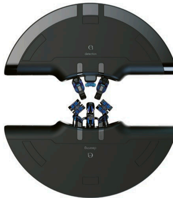
Abb. 2 Im geschlossenen Zustand sieht das Device aus wie eine runde Sound Box, die sich zu zwei Halbmonden öffnen lässt und ein detection und ein cleaning device zum Vorschein kommen.
